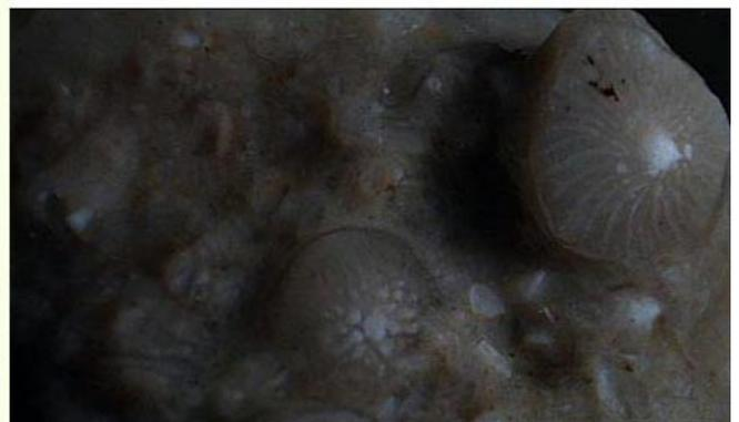
**Diascopia: esame di soggetti trasparenti, nel caso una sezione sottile di granito.**
