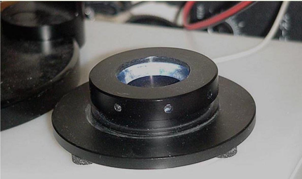
Un accessorio molto utile è poi il sistema di illuminazione in luce polarizzata, che potrete usare sia in episcopia per eliminare totalmente i riflessi di oggetti lucidi, oppure per visualizzare in diascopea oggetti trasparenti, ad esempio delle sezioni di minerali o dei depositi cristallini.
